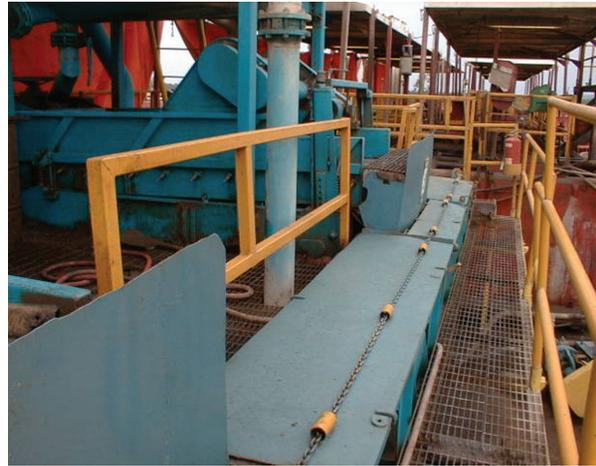
El transportador de tornillo BRANDT permite el fácil transporte de los sólidos perforados. Por lo general, los transportadores de tornillo se usan para transportar los recortes perforados desde el área de la zaranda a una compuerta de descarga, patín o un equipo de procesamiento secundario.
